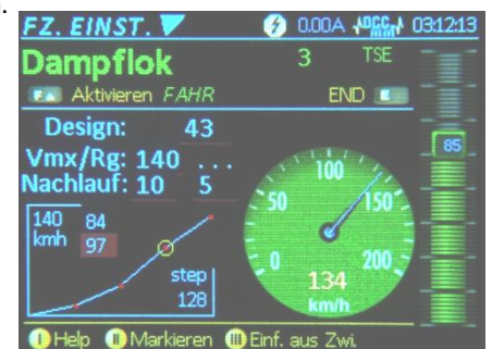
Fahrzeugeinstellungen: hier werden Vorgaben zur Darstellung des Fahrzeugs im FAHR - Zustand gemacht, wie beispielsweise das Anzeigeverhalten des Tachos: wenn keine echte Rückmeldung (RailCom) aus der Lok vorhanden ist, muss die aktuelle Geschwindigkeit aus der Fahrstufe abgeleitet werden, nach einer zu definierenden Relation und in einer zu definierenden Nachlaufzeit; außerdem kann eines unter mehreren Tacho-Design ausgewählt und der Rangierbereich festgelegt werden.
