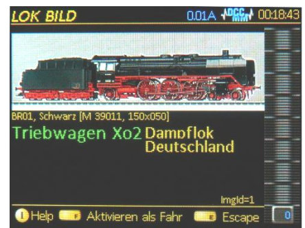
Auswahl eines Lok-Bildes aus einer nach Ländern und Fahrzeugarten gegliederten Bibliothek; auch Einspielen eigener Fotos möglich (Darstellung in Entwicklung)
