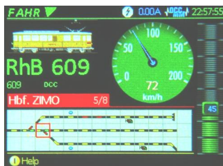
Bildschirm des MX32 im FAHR - Zustand; zwei von mehreren möglichen Darstellungen: mit großem Bild, mit kleinem Bild, ohne Bild, mit Funktions-Icons, mit Stellwerks-Auszug, mit Vorschau-Liste, ...
