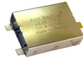
MASSE-Anschlüsse Pluspol (ACHTUNG: MASSE mit Gehäuse verbunden)
