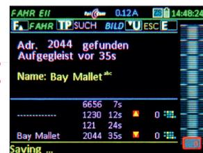
Die „Aufgleissuche“ wird verwendet, um die **unbekannten Adresse(n)** eines oder weniger Fahrzeuge zu **finden**. Das aktuell gesuchte Fahrzeug wird kurzzeitig stromlos gemacht:
