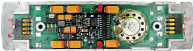
Lokplatine einer schwedischen „Class Du“ mit aufgestecktem Sound-Decoder MX644 (MTC-Schnittstelle). Integriert auf der Platine ist ein Energiespeicher aus 6 Tantals (gesamt 1300  $\mu$ F).
