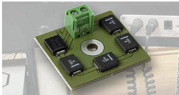
Das **LENZ ABC** funktioniert durch die Asymmetrie der DCC-Spannung. **ZIMO Decoder** benötigen eine sehr deutliche Asymmetrie.
