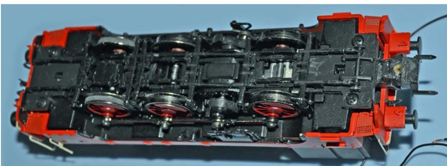
Beide Teile zusammengedrückt halten (Klammer), die Litzen durch die vorhandenen Bohrungen im Fahrwerk #137397 ziehen, schieben bis die Zapfen einrasten (Klammer entfernt) und mit den 2 Schrauben M1.6x4 befestigen.
