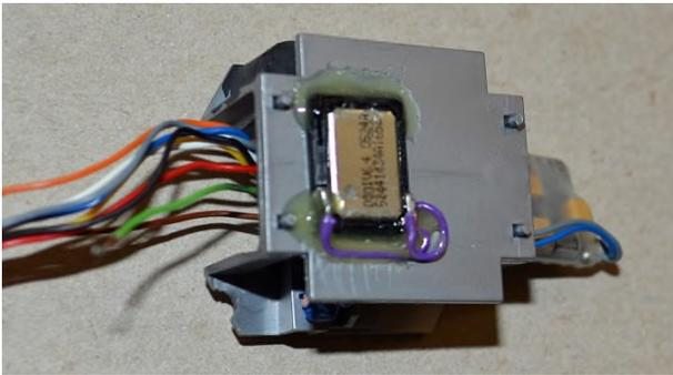
ZIMO LS 10 x 15 und der Speicherkondensator wurden auch in der Inneneinrichtung untergebracht.
