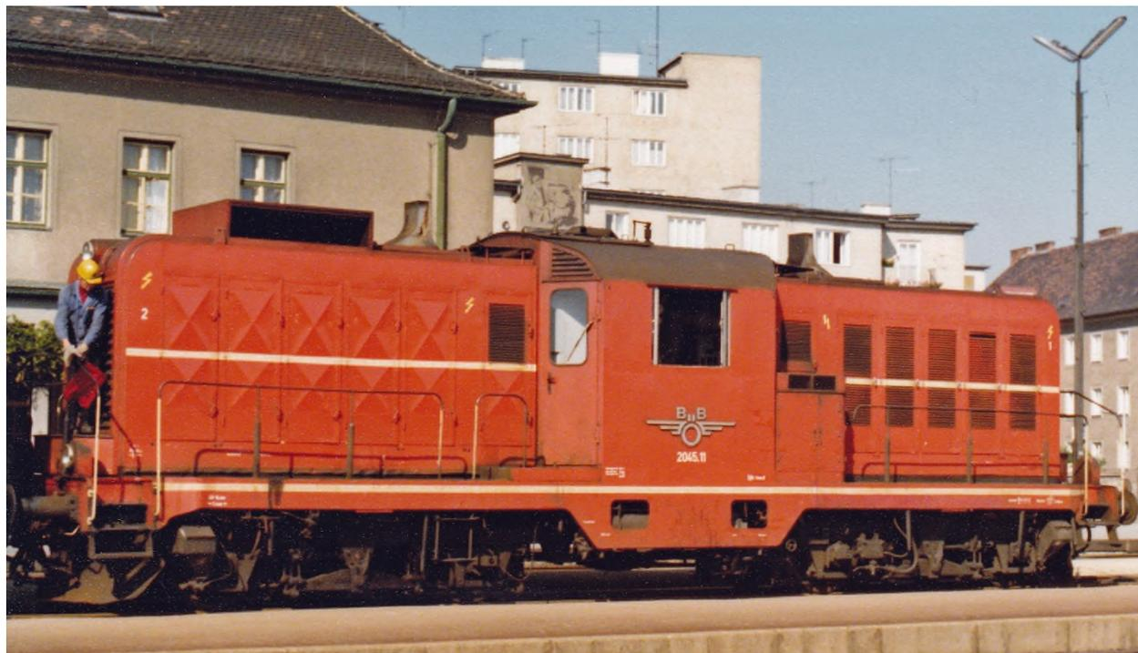
Design: Zwitterversion Blutorange-Elfenbein, Dach (war) Silber, ÖBB-Flügelrad. Durch die beidseitig gleichen, auswechselbaren Vorbauten konnte man solche verschiedene Umbauversionen beobachten. Vorbau 2: schon schallgedämpft und mit geschlossenen Türen. Vorbau 1: nicht schallgedämpft, Türen mit offenen Luftschlitzen.
