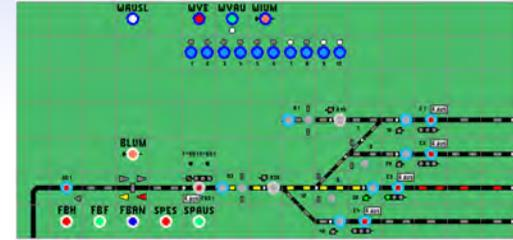
Die Daten der Anlage werden menügeführt mittels Editoren eingegeben, wobei das auf dem Bildschirm erzeugte Pult als Referenz für die meisten Eingaben dient. Derzeit kann unter 4 unterschiedlichen Darstellungen für deutsche Stellwerkssysteme gewählt werden; neu ab V7 wird auch das Schweizerische Dmo67 angeboten, das sowohl optisch, als auch funktionell eigenständig ist.
