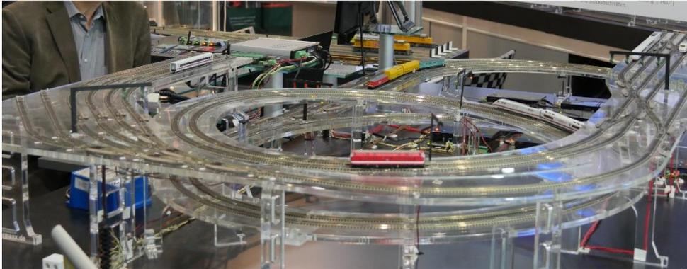
Es gibt drei „Bahnhöfe“, zwei davon Kopfbahnhöfe, mit insgesamt 12 Gleisen, 3 Strecken im Blockbetrieb und eine Kehrschleife.
