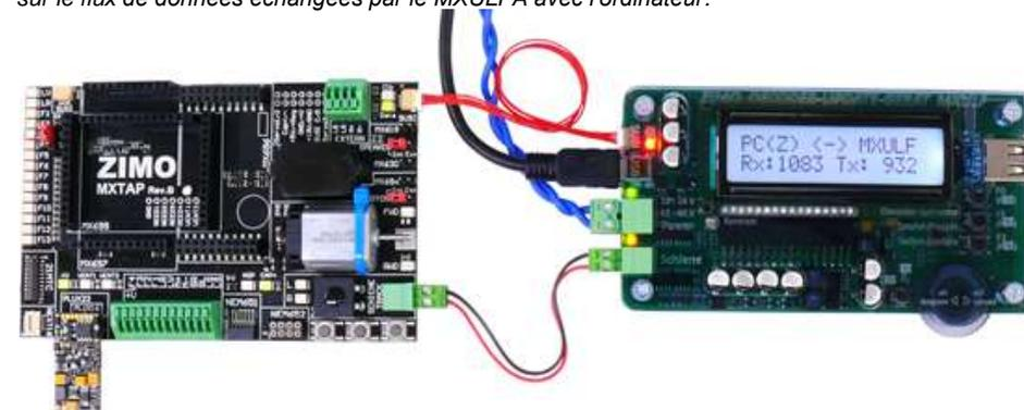
**MXTAPV** avec un décodeur MX648N18 (Next), connecté à un **MXULFA**:
