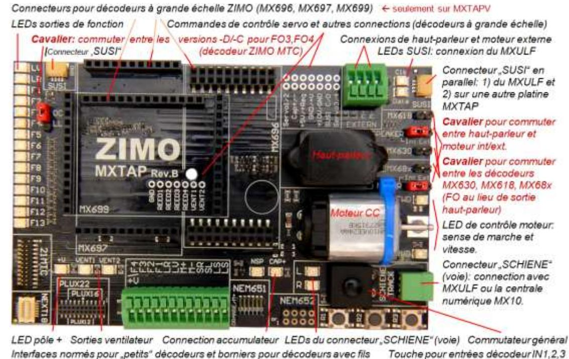
Les connexions entre le MXTAPV et le MXULF: un câble à 2-pôles raccordant les connecteurs "Schienne" (voie; prises fournies) et un câble à 4-pôles „SUSI" (fourni; SUSIKAB)
