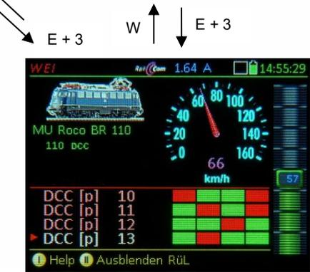
Umschaltpfade zwischen den Zuständen „normaler Fahrbetrieb“ FAHR, Betriebszustand WEI, sowie ZUB LISTE.
