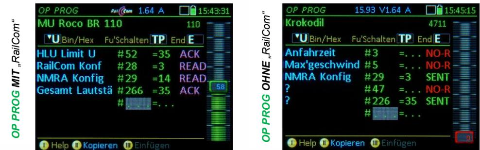
**E-Taste** → **Beenden des CV-Programmierens** (auch: **Unterbrechen** eines laufenden Vorgangs) bzw. Beenden des Adressierens und Rückkehr in den Auswahlbildschirm
