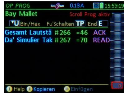
Softkey III = ... **einfügen** → Suchen des gewünschten CV-Sets aus dem CV-Set-Speicher und Anfügen der CV-Set-Zeilen an die aktuelle Bildschirm-Ansicht.
