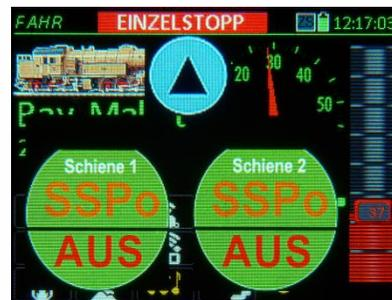
Touch auf „SSPo“ Schiene-1 links in diesem Fall „FS 0“ - Bremsung, weil in **PULT CONF** so eingestellt
