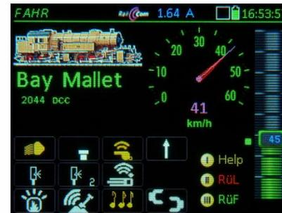
**TOUCH auf Bild (in Normalansicht I)** → Bild wird groß, Tacho geht nach unten. Dadurch gibt es allerdings KEINE Funktionssymbole zu sehen.
