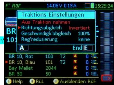
**Entfernen eines Fahrzeugs aus einer Traktion bzw. Auflösen einer Traktion:**
