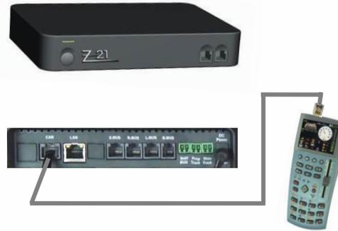
An der **ROCO Zentrale Z21** (Anschluss „CAN“) wird empfohlen maximal **3 ZIMO Fahrpulte MX32** oder **1 Funkfahrpult MX32 FU \*** mittels 6-poligem CAN-Kabel anzuschließen.
