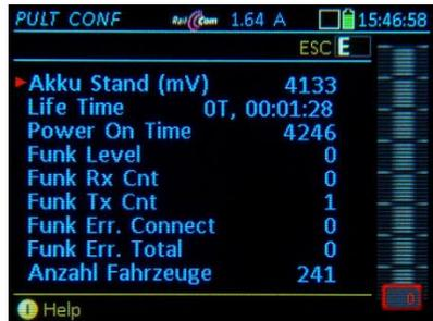
**Akku Stand (mV)**: Zeigt die aktuelle Akku-Spannung
