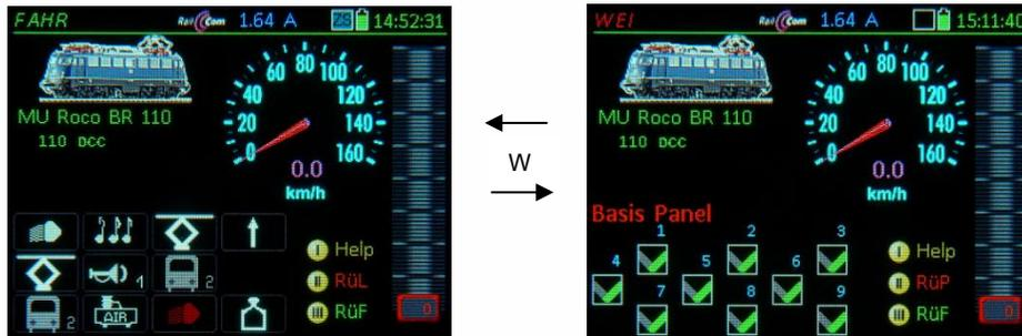
Zifferntasten **1 - 9** → Schalten der sichtbaren Felder. Den 18 Feldern des „Basis-Panels“ sind die Adressen 10.0, 10.1, 10.2, 10.3, 11.0, 11.1, 11.2, ... zugeordnet, also die Zubehör- (= „Magnetartikel-“) Adressen ab 10, jeweils mit allen 4 Subadressen (0 - 3).
