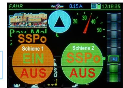
in diesem Fall „Emergency“-Bremsung bei Sammelstopp, weil in **PULT CONF** so eingestellt)
