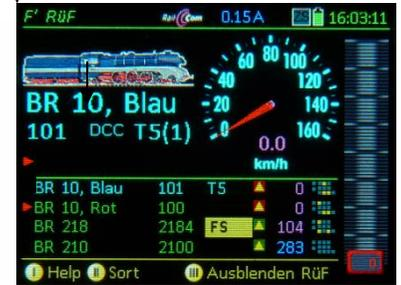
Scroll im **RüF** zu „BR10 rot“, welche zweite Traktionslok werden soll, TP, 5, um diese mit „T5“ zu markieren
