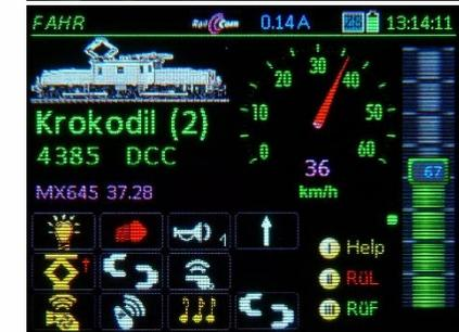
Die „gegenteilige Richtung“ des Klonens, also das **„Klonen aus Ursprung in ObjDB“** wird häufig verwendet, um **für eine neue Lok** einfach und schnell eine **passende GUI** zu finden oder als Grundlage einzusetzen.
