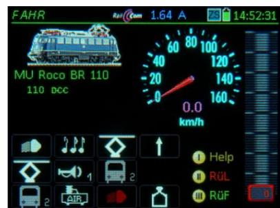
**HINWEIS:** im Falle von **WEI** als Startbildschirm sind die Zifferntasten den Weichen des angezeigten Panels zugeordnet. Um mit den Tasten Lokfunktionen zu schalten: mit **F-Taste** in **FAHR** wechseln! ►
