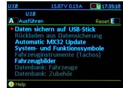
Wenn sich eine **Datensicherung** am USB-Stick befindet – diese kann **vom Gerät selbst** oder auch **von einem anderen Fahrpult** stammen! – wird als zweiter Eintrag „**Rückladen der Datensicherung**“ und - nach Auswahl - die Liste der gesicherten Daten sichtbar.
