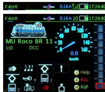
Bei schlechter Empfangszahl (selbst bei guter Feldstärke **kann** es sich um Störungen durch fremde Funknetze, wie WLAN, handeln) empfiehlt sich zunächst ein **Wechsel des Funkkanals** am Basisgerät: Aus Normalbetrieb Taste 2 → MENÜ, dort „Funk Kanal“ auswählen (Drehknopf), aktivieren (Drehknopf drücken), Kanalnummer ändern (Drehknopf).
