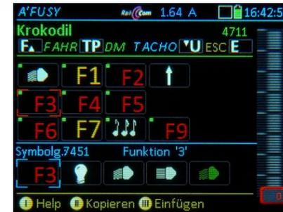
→ Fu-Taste, Scrollen durch Symbole-Leiste, TP-Taste für Dauer/Moment-Auswahl, nächste Fu-Taste, usw.
