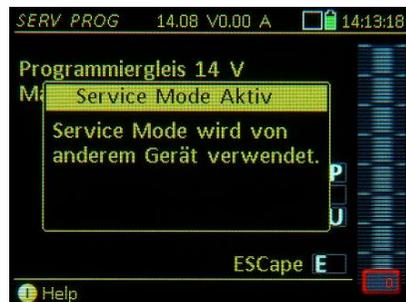
Auf den **anderen Fahrpulten** wird angezeigt, dass die Schiene-2 des Basisgerätes (falls das Basisgerät zwei Schienenausgänge hat, ansonsten das Gerät als Ganzes) im Service Mode ist.
