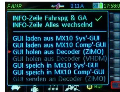
A-Taste → Die File-Übermittlung wird gestartet und läuft nun sichtbar für den Anwender ab, d.h. es kann das Eintreffen der verschiedenen GUI-Elemente (Lokbild, Name, Tacho, Funktionssymbole, ...) mitverfolgt werden (auf Wunsch auch Abbrechen möglich). Auch eventuelle Übertragungsstörungen sind dabei zu erkennen: leer bleibende Symbole, und spätere automatische Nachlieferung.
