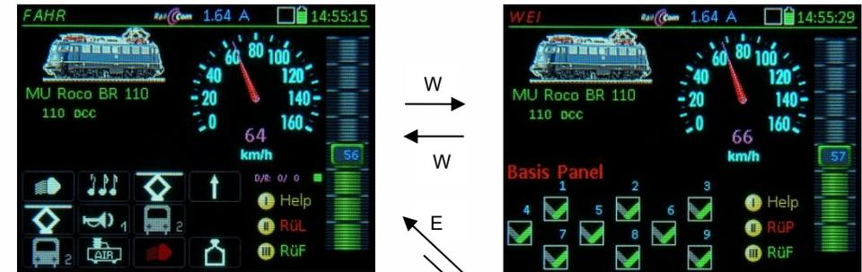
Im Betriebszustand WEI wird also ein Weichen-Pan-Panel (oder die Sonderform Weichenstraßen-Panel) angezeigt Die Felder der Panels repräsentieren „Objekte“, d.s. einzelne Zubehör-Artikel oder Fahrstraßen. Die Zifferntasten des Fahrpults sind den 9 sichtbaren Feldern (und damit diesen Objekten zugeordnet. z.B.: Stell-Feld 5 <-> Taste 5 (F4)
