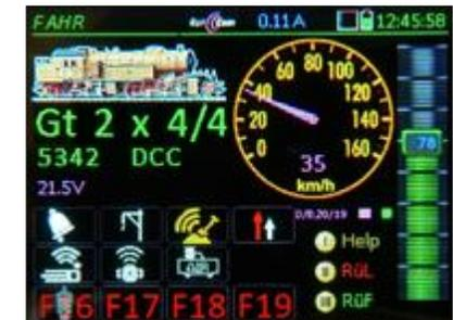
Die GUI-Übermittlung ist komplett, wieder Anzeige der ersten Ebene Funktionssymbole Fahrbetrieb läuft unverändert weiter; GUI-Übermittlung wäre auch fertiggestellt worden, wenn Adresse zwischenzeitlich aus dem Vordergrund genommen worden wäre.
