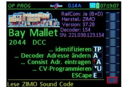
Bei Eintritt in den Betriebszustand **OP PROG** gelangt man zunächst in einen Auswahlbildschirm; OBEN ist die Situation dargestellt, bei der der Decoder **über RailCom rückmeldefähig** und damit „identifizierbar“ ist: Informationen wie Hersteller, SW-Version, und Decoder-ID werden automatisch ausgelesen und angezeigt (in der Farbe Magenta, der RailCom-Kennfarbe);
