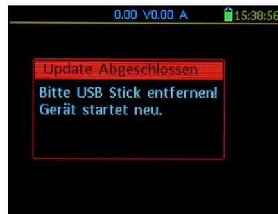
Nach dem Update wird die **Aufforderung zum Entfernen des USB-Sticks** angezeigt, danach erfolgt (immer) ein **automatisches Reset** und Hochfahren des MX32.
