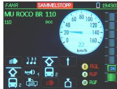
„SAMMELSTOPP“ und „AUS Schiene“ sind **Systemzustände** (im Gegensatz zu EINZELSTOPP); daher erscheint das passende STOPP-Fenster auf allen Fahrpulten; ein solcher Systemzustand kann gleichermaßen von allen Fahrpulten her aufgehoben werden (**S-Taste**).
