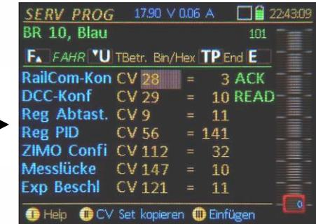
**ACHTUNG:** Mit dem „Einfügen“ sind die CV-Zeilen zunächst nur gelistet, aber noch NICHT durchgeführt. Dies muss erst für jede Zeile einzelnen vorgenommen werden; d.h. in der Praxis:
