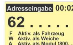
Nach Aktivierung mit F+F (zweimal A, als Fahrzeug) oder Taste W (als Weichenadresse) oder A (als MX8- oder MX9-Modul) Wechsel in den FAHR-(grün) oder WEI-Zustand (rot).
