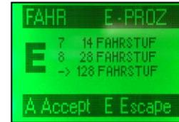
Default-mäßig sind 28 Fahrstufen eingestellt; dies bedeutet, dass Decoder, die auf 28 oder 128 Fahrstufen eingestellt sind, korrekt funktionieren, nicht jedoch solche mit 14 Fahrstufen (meistens ältere Typen oder LGB – die Fehlfunktion ist vor allem an den Stirnlampen zu erkennen). Zur vollen Ausnutzung von modernen Decodern (128 Fahrstufen) sollte auch das Fahrpult auf 128 umgestellt werden (für jede einzelnen Adresse oder über Menü gesamt).
