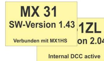
Nach 2 sec (oder sofort bei Betätigung einer Taste) Wechsel in FAHR- oder WEI-ZUSTAND (je nach letzter Betriebs-Phase); oder bei Erstinbetriebnahme in die "Adresseingabe".
