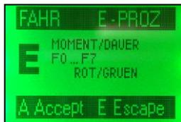
Die Auswahl zwischen Dauer- und Momentwirkung für die einzelnen Funktionstasten erfolgt mit diesen Tasten selbst; die zugehörigen LEDs zeigen während der E-Prozedur M/D die aktuelle Einstellung an: grün = Dauer, rot = Moment.
