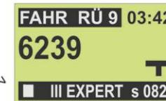
FAHR-Zustand zum Steuern eines Fahrzeugs; WEI-Zustand zum Schalten einer Weichen-Gruppe und gleichzeitig Steuern des zuletzt aktiven Fahrzeugs; Deaktivierung mit Taste A zur Adresseingabe.
