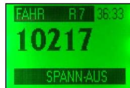
Einzelstopp (nach Betätigung **S**)    Sammelstopp (nach **↑-S** oder **2 x S**)    Fahrspannung-AUS (nach SSP **↑-S**)
