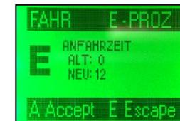
Das hier eingestellte Anfahr- und Bremsverhalten hat nichts zu tun mit den Konfigurationsvariablen (CV # 3, 4) in den Decodern; es wird hier rein mit der Abfolge der Fahrbefehle gearbeitet, wie sie vom System ausgesendet werden. Beide – systemgesteuerte und decoder-gesteuerte Anfahr- und Bremsabläufe – ergänzen sich im resultierenden Fahrverhalten.
