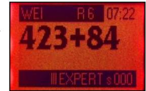
WEI - Zustand im OPERATOR-Modus mit verknüpfter Zweit-Magnetartikeladresse
