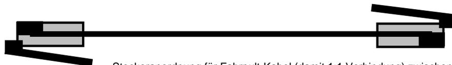
Steckeranordnung für Fahrpult-Kabel (damit 1:1 Verbindung) zwischen Basisgerät MX1 und Fahrpult MX2 bzw. von Fahrpult zu Fahrpult.
