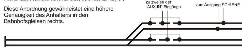
Diese Anordnung gewährleistet eine höhere Genauigkeit des Anhaltens in den Bahnhofsgleisen rechts.
