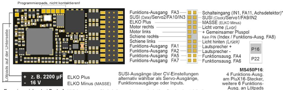
Energiespeicher bei Bedarf (üblicherweise auf Lokplatine und automatisch über Stecker kontaktiert) ELKO oder Goldcaps 16 V, unbeschränkte Kapazität
