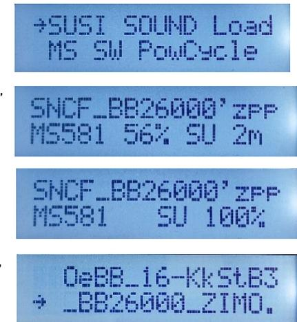
\*) Falls sich mehrere .zpp-Files am Stick befinden, werden diese angezeigt; es muss eines mittels Scrollen ausgewählt werden. Bestätigung mittels R
