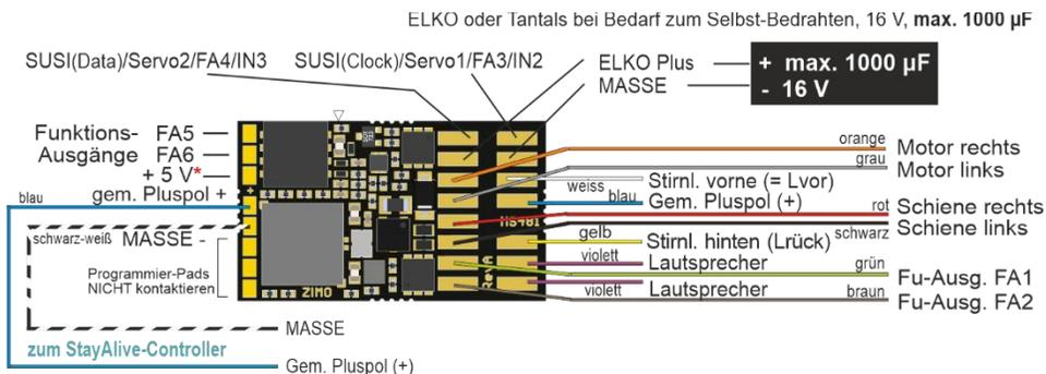
\* stabilisierte +5 V, max. 200 mA Funktions-Ausg. FA5, FA6 auf Löt-Pads zum Selbst-Bedrahten
