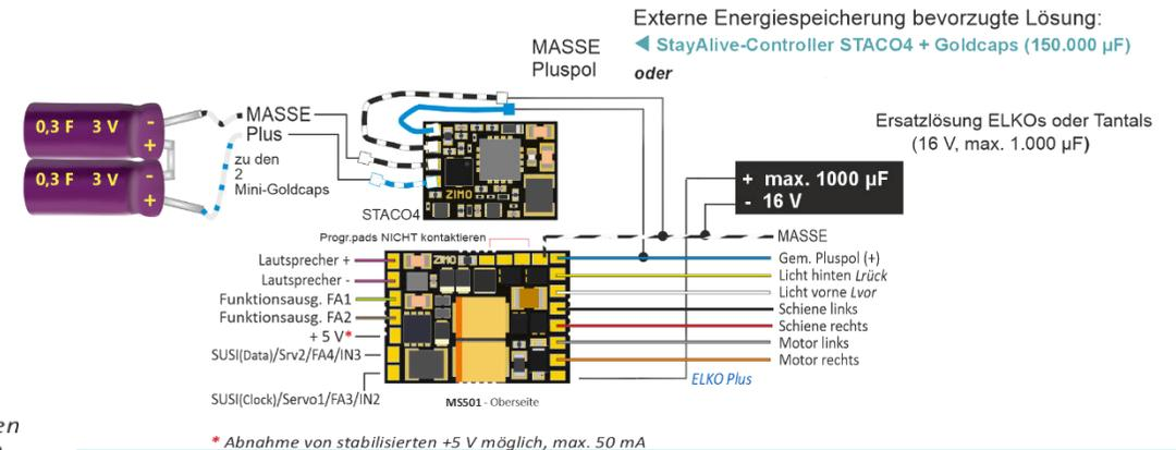
\* Abnahme von stabilisierten +5 V möglich, max. 50 mA
