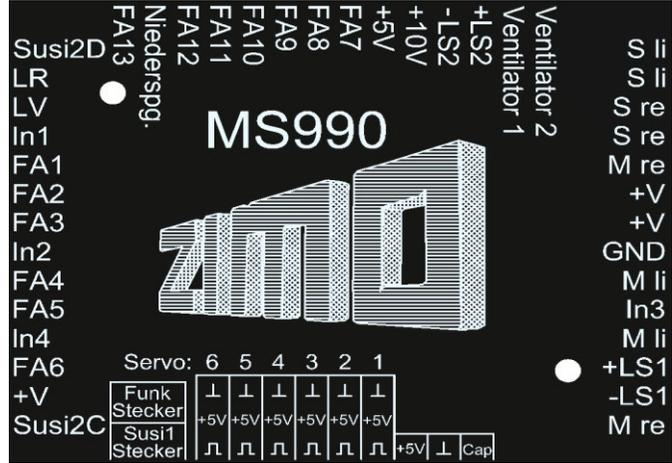
Die Bodenplatte der Großbahn-Decoder MS990L und MS990K
