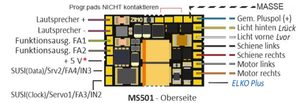
\* Abnahme von stabilisierten +5 V möglich, max. 50 mA
