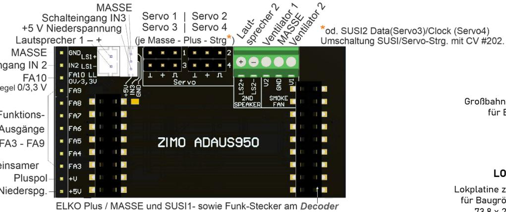
**Anschluss Rauchgenerator an LOKPL950K**
