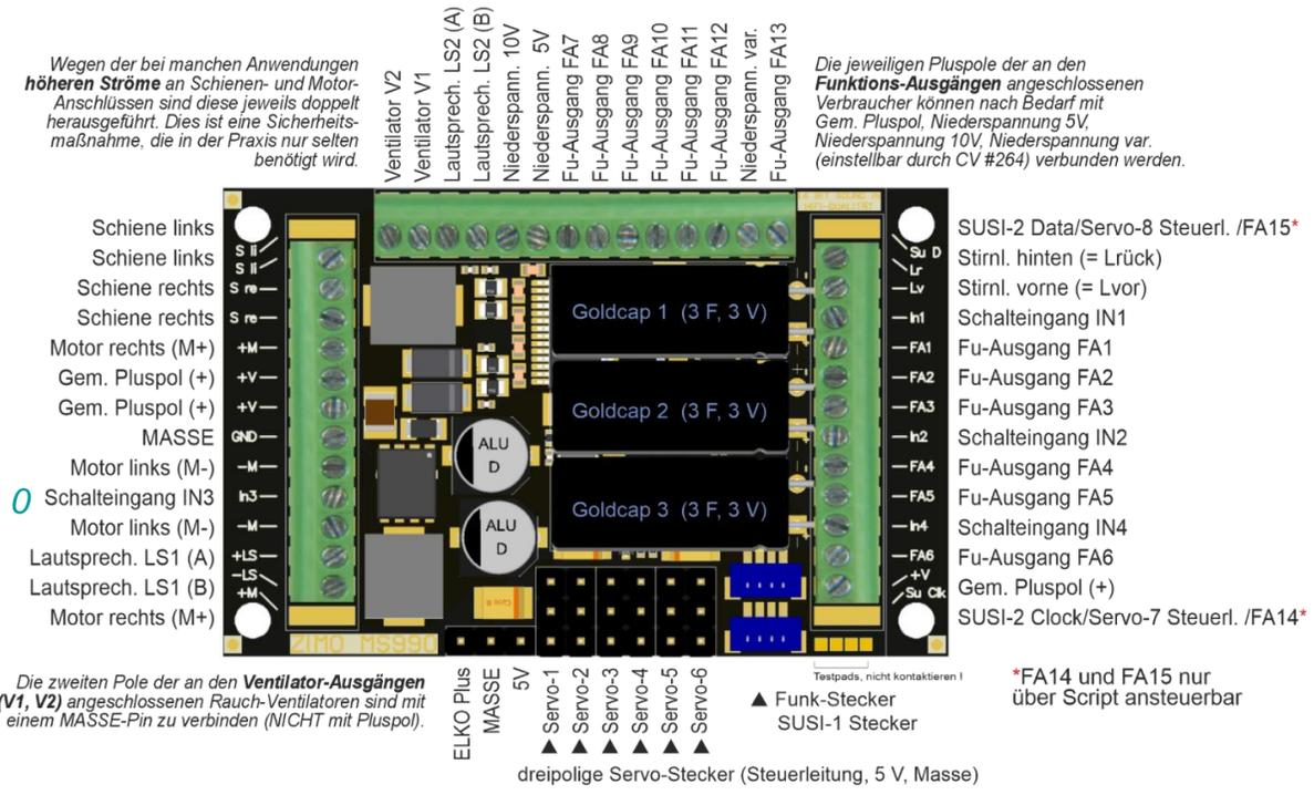
Der Anschluss „ELKO Plus / MASSE“ für zusätzliche externe Energiespeicher an den Decodern MS950 und MS990.
