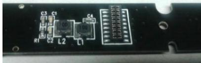
**Abhilfe:** Der „schädliche“ Kondensator auf der PIKO-Lokplatine ist üblicherweise mit „C4“ gekennzeichnet, dieser muss entfernt werden. Dazu muss normalerweise die Lokplatine entnommen werden, weil der Kondensator auf der Unterseite bestückt ist.
