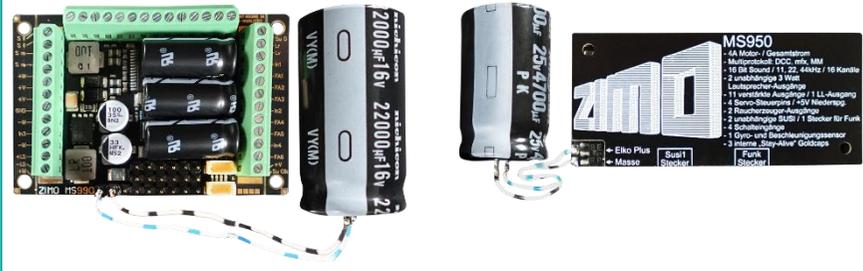
Noch besser ist es, wenn für die Versorgung der Lämpchen (die in diesem Fall LEDs sein sollten) **nicht der „Gem. Pluspol“** verwendet wird, **sondern eine geregelte Niederspannung**. Die Decoder des Typs MS950 haben dafür die „Servo-Spannung 5 V“ (sollte nicht mit mehr als etwa 200 mA zusätzlich belastet werden). MS990 auch die „Niederspannung 10 V“ (gleichzeitig Audiospannung, sollte nicht mit mehr als 500 mA belastet werden) und eine „Niederspannung variabel“.
