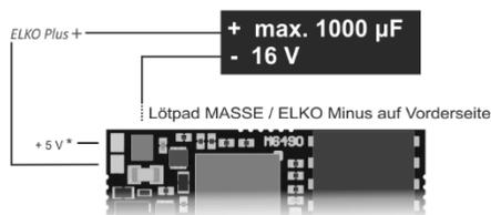
\* Abnahme von stabilisierten +5 V möglich, max. 50 mA
