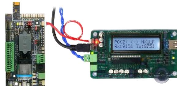
Decoder-Sound-Laden mittels **USB-Stick** über die **Schiene** (Decoder eingebaut in Lok)
