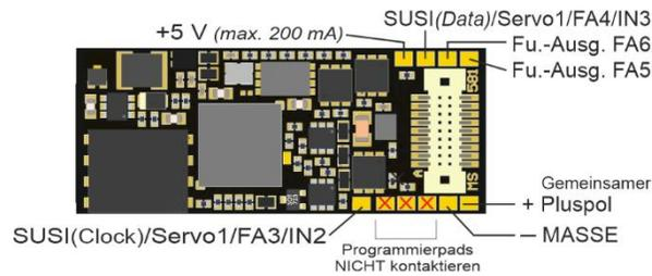
**MS581N18** Unterseite, mit opt. externer Erweiterung des Energiespeichers
