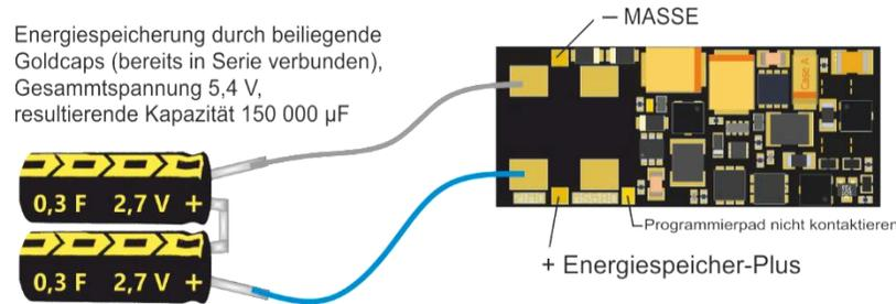
(OHNE Tantals auf Decoder, aber Drähte zu externem Energiespeicher. Zwei verbundene GoldCaps liegen der Packung bei, diese können an die offenen Enden der Drähte angelötet werden. POLARITÄT BEACHTEN!)
