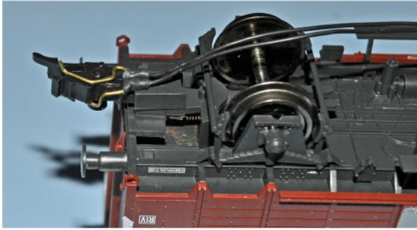
Bedingt durch die Litzenlötlungen, isoliert durch Schrumpfschläuche, können die Kupplungen nicht bis zur Einrastung in einen geschlossenen Normschacht eingesetzt werden.
