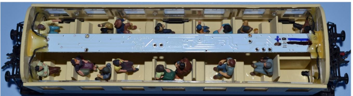
Zwei 1.0 mm dicke und 2.0 mm breite Kunststoff-Abstandshalter zuschneiden und mit einem Sekundenklebstoff je einen auf beide Fenstereinlagen der Stirnseiten kleben. Lichtleiste auflegen, LED's müssen frei nach unten sein und mit einem Sekundenklebstoff fixieren. Litzen auf Länge kürzen, abisolieren und auf die Löt pads löten. Links: Schienenstrom, Rechts: DC-Strom +Pol blau, -Pol braun. Klebungen und Lötungen mit einem 2K-Klebstoff sichern.
