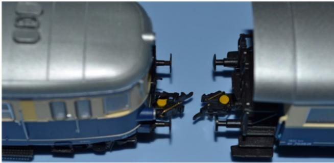
Schienenstromführende Kupplungsköpfe am ÖBB 5042.08 Triebwagen und am ÖBB BT 7039.01 mit gelber Farbe markieren.
