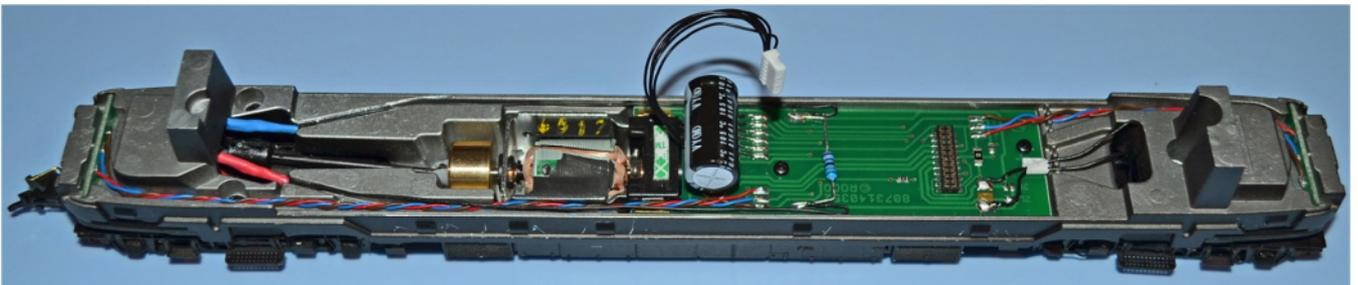
Lötstellen mit einem Schrumpfschlauch isolieren, sauber verlegen und an die Schienenstrom-Löt pads löten. Bei Einsatz des Lenz ABC gleichzeitig einen 2k2-Widerstand anlöten.
