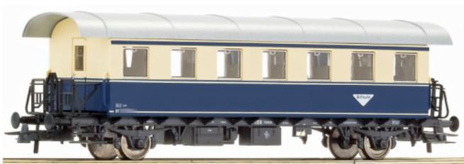
Dieser Wagen wird mit dem Abschnitt einer E-Modell LX-U DCC-Decoder LED Lichtleiste und auf beiden Stirnseiten mit einer DC-Stromführenden-Kupplung ausgerüstet.
