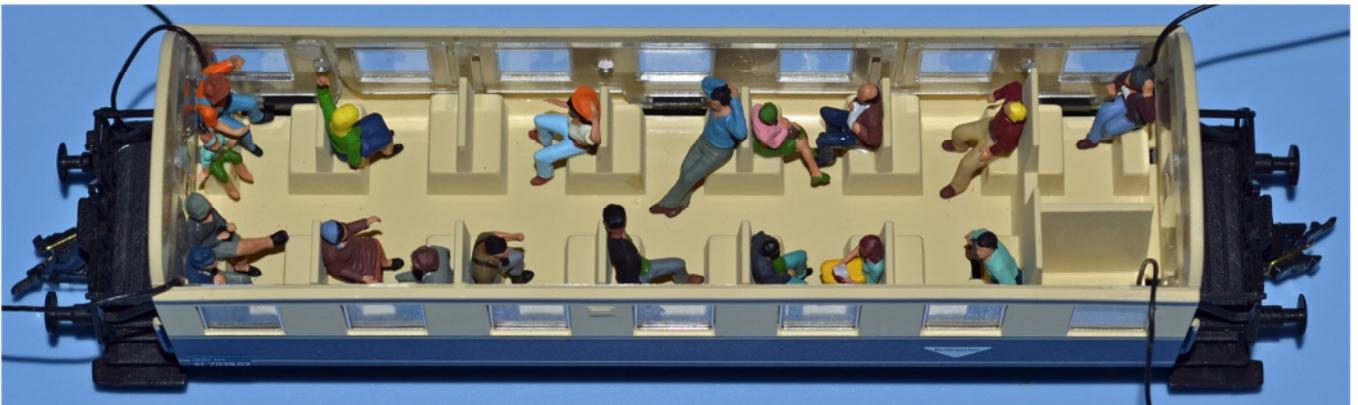
Figuren mit einem Sekundenklebstoff einkleben, gleichzeitig die Bohrungen abdecken und die Litzen in den Ecken befestigen.
