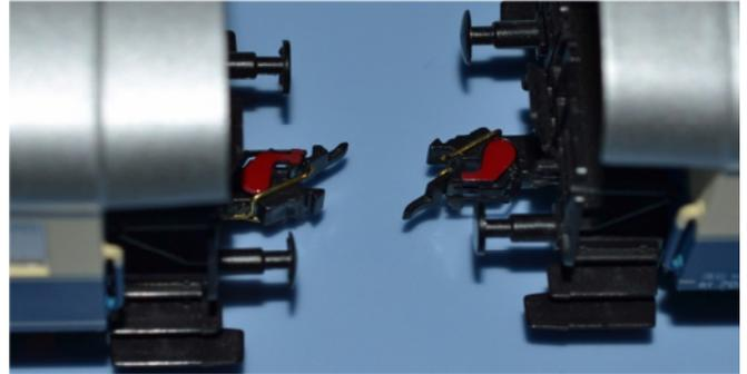
DC-Stromführende Kupplungskopf am ÖBB BT 7039.01 (und später am ÖBB BT 7039.02) mit roter Farbe markieren.
