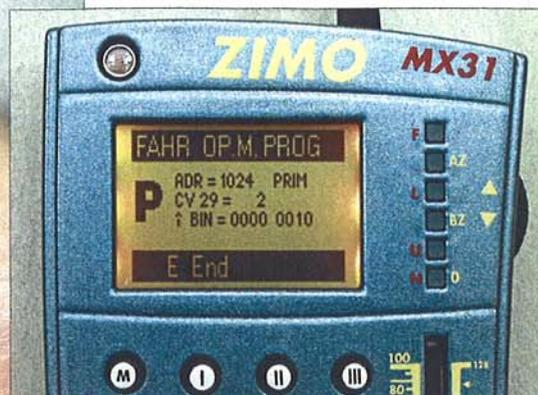
Gelbes Display: hier das Programmieren während des Betriebs (POM). Bits werden mit den Zifferntasten 0...7 gesetzt oder gelöscht, auch Dezimaleingabe möglich.
