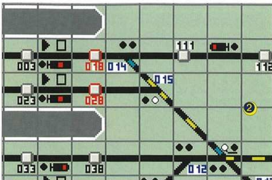
Die Fahrstraße läuft ein, die Weichenfelder zeigen blau blinkend den noch andauernden Umlauf der Weichen 13 und 14 an.
