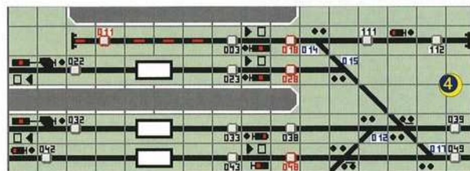
Gleis 1 zeigt mit roter Ausleuchtung, dass das Gleis belegt ist, und die Verschlussmelder der Weichen signalisieren Grundstellung.
