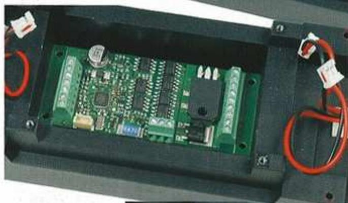
Links: Der Decoder Gold Maxi von Lenz findet am Boden der Mulde leicht Platz, wenn man die Decoderplatine vor den Anschlussklemmen kürzt.
