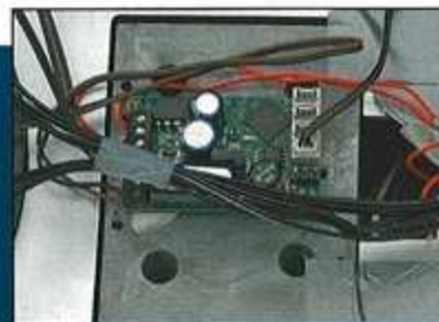
Das Soundmodul von Champex Linden funktioniert auch analog. Es benötigt im Digitalbetrieb einen Lokdekoder.
