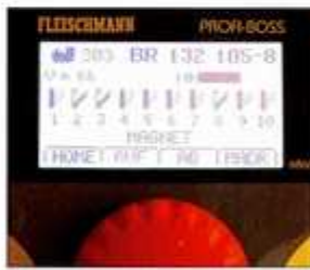
▲ Während des Fahrbetriebs können auch Weichen geschaltet werden, die durch den schraffierten Weichenstrang die Stellung anzeigen.
