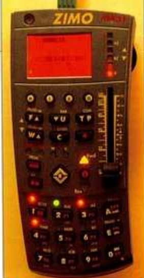
▲ Bei roter Displaybeleuchtung befindet sich die Zentrale MX31ZL im Weichenmodus. Die vier Tasten mit den leuchtenden LED dienen zur Weichenumstellung.
