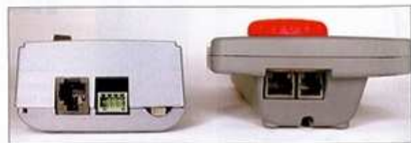
Die Steckanschlüsse an den Stirnseiten der Digitalzentralen
