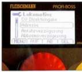
▲ Im Programmier-Menü, erkennbar am Schraubenschlüssel-Symbol, kann zwischen konventioneller CV-Eingabe und einigen mit Klarnamen bezeichneten CV gewählt werden.
