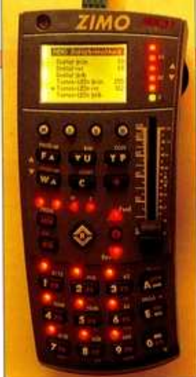
▲ In mehreren Menüpunkten kann die Helligkeit der Tasten und der Displaybeleuchtung optimal eingestellt werden. Einstellbar sind jedoch nur Rot (wie abgebildet) und Grün.
