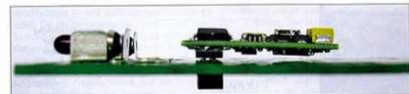
◀ Prototyp der PluX22-Schnittstelle auf der Platine eines aktuellen Fleischmann-Lokmodells; zusätzlich ist die bekannte achtpolige NEM-652-Schnittstelle vorhanden.
