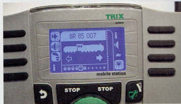
Zimo: Anmeldung der Roco-85 007 mit dem Zimo Nachrüstdecoder MS450 an der Trix-Mobile-Station 2
