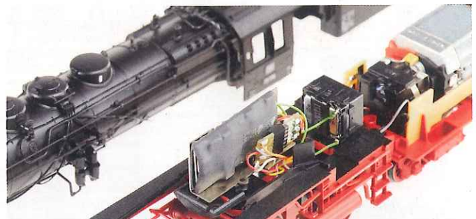
Gut erreichbar: Die digitale Schnittstelle und der Decoder befinden sich gut zugänglich im Stehkessel des Modells.
