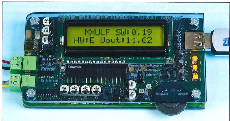
Der Zimo-Programmer mit gestecktem USB-Stick, von dem die zu schreibenden Daten gelesen werden müssen. Eine PC-Anbindung wird es erst in einer der nächsten Ausbaustufen geben.
