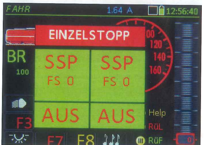
Ein lokbezogener Halt lässt sich durch die rote 5-Taste am Regler auslösen. Ein Sammelstopp wird durch längeres Drücken aktiviert.
