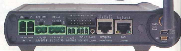
Die MX10 bietet zahlreiche Anschlüsse, der Handregler MX32 besitzt ein Farbdisplay. Die kleine Anzeige der Zentrale dient zur Einstellung des Geräts.
