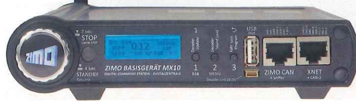
Die MX10 bietet zahlreiche Anschlüsse, der Handregler MX32 besitzt ein Farbdisplay. Die kleine Anzeige der Zentrale dient zur Einstellung des Geräts.
