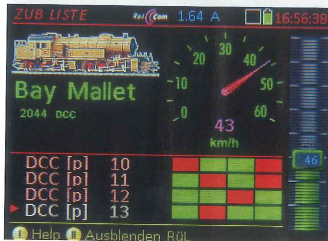
Mit dem MX32 lassen sich Weichen komfortabel schalten: Nachdem die Auswahl erfolgt ist, muss die Softkey-Taste gedrückt werden.
