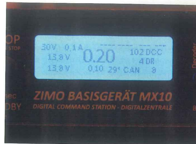
Die hellblaue Anzeige der MX10 versorgt den Modellbahner mit Informationen wie Eingangsspannung (30 Volt) und Strom (0,1 A).
