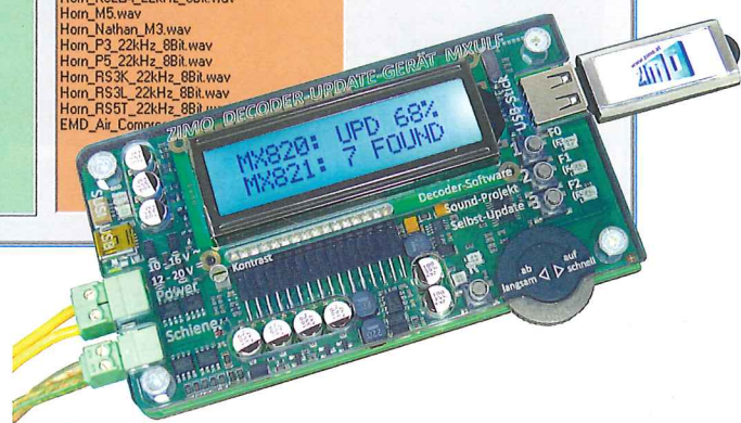
Die Software Soundprogrammer von Zimo und das Updategerät MXULF mit USB-Schnitt zum Laden des Sound von einem USB-Stick.
