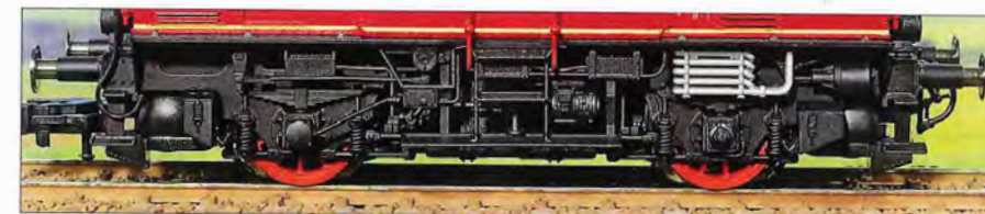
Am Fahrwerk findet man viele Details, die zum großen Teil separat angesetzt sind. Oben die rechte Seite: Sifa, Zwischenkühler der Druckluftanlage, Bremszylinder. Unten die linke Seite: Hilfsluftbehälter, darunter die Schmierpumpe, besonders auffällig: die weiß-rot gestrichene Erdungsstange. Bei der DB-Version wird die beiliegende Leiter nicht montiert.
