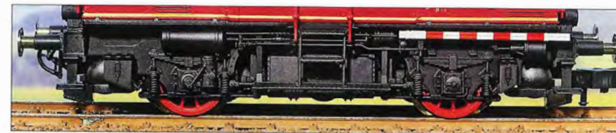
Am Fahrwerk findet man viele Details, die zum großen Teil separat angesetzt sind. Oben die rechte Seite: Sifa, Zwischenkühler der Druckluftanlage, Bremszylinder. Unten die linke Seite: Hilfsluftbehälter, darunter die Schmierpumpe, besonders auffällig: die weiß-rot gestrichene Erdungsstange. Bei der DB-Version wird die beiliegende Leiter nicht montiert.
