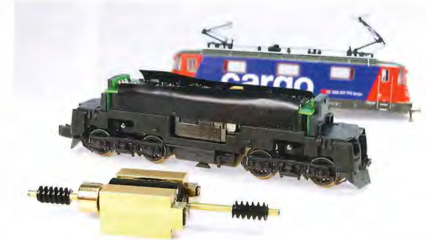
Der in die Lok passende Tauschsatz von sb-Modellbau liegt zur Montage bereit.
