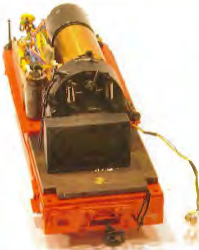
Beim Blick zum Führerstand sieht man rechts das zweipolige Kabel zu den hinteren Loklaternen und links stehend den Energiespeicher
