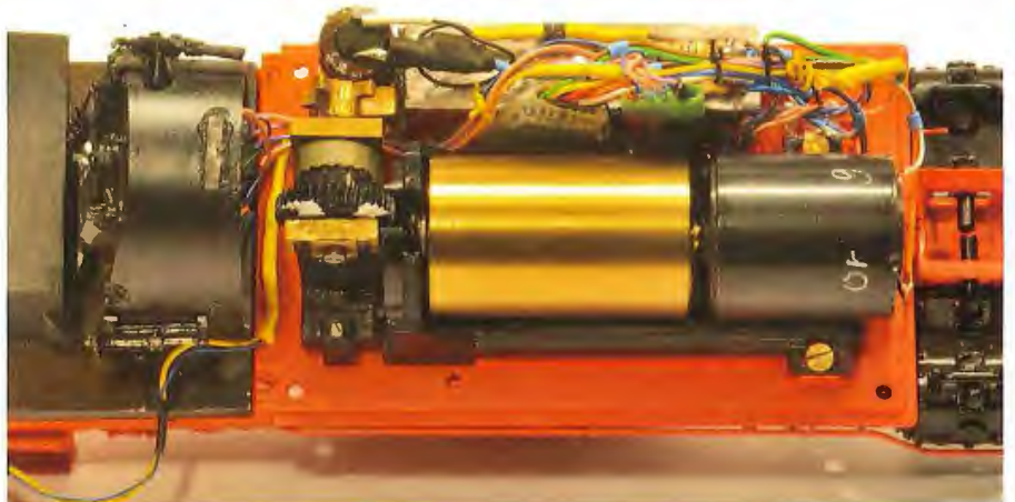
Das Innere der Lok nach dem Decoder-Tausch: Oberhalb der Schwungmasse sieht man links den Zimo-Decoder im durchsichtigen Schrumpfschlauch sowie daneben den Stecker für die Susi-Schnittstelle im grünen Schrumpfschlauch mit den vierfarbigen Pins
