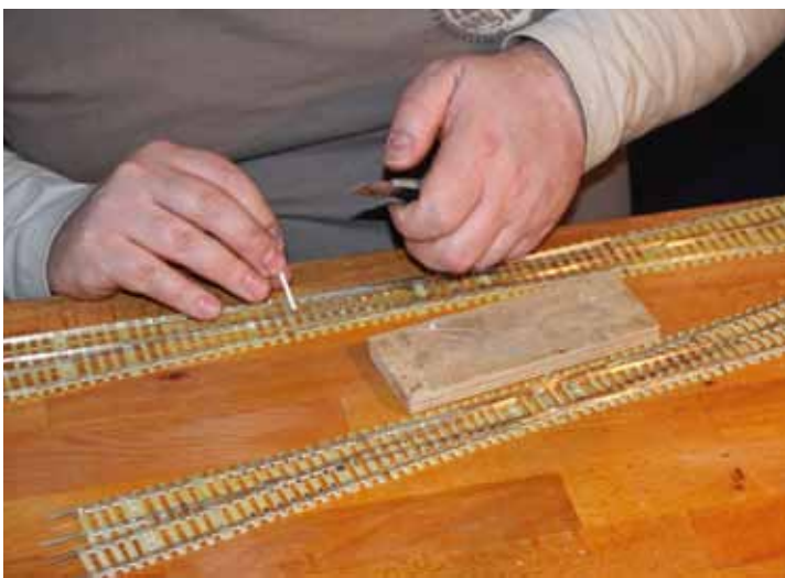
Miniworkshops har blivit en stor grej. Det finns rader av bord där olika experter under hela mässan bygger och visar sina färdigheter. Ofta inbjuds man att slå sig ner och "lära sig" någonting i byggväg. Här lär Rainer ut den fina konsten att bygga egna växlar. Han startar med en knippe lång räler (ungefär som en ståltråd), profilsågade faner-bitar och en påse finsand. I snitt bygger han en växel per dag, inklusive all tid för förklaringar och torktid.
