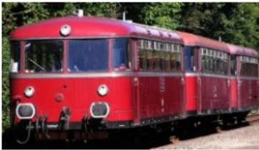
Der VT 98.9 wurde aus dem VT 95.9 entwickelt, der für viele Strecken mit einem Fahrmotor zu schwach motorisiert war. Der VT 98.9, konstruiert von der Waggonfabrik Uerdingen, hat zwei Büssing Flachboxermotoren, das hört man deutlich beim Starten. Die Kraftübertragung erfolgt über ein mechanisches 6-Ganggetriebe. Das verursacht das typische mehrfache Hochlaufen der Motoren.
